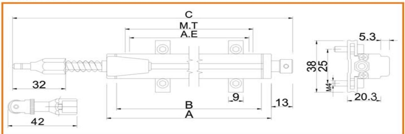
**应用范围:** KTR是微型自恢复式，特别适合空间狭小安装不便的场合。如：中空吹瓶机、IT设备、张力调节、高速冲自动送料机、速度调节、印刷机械、纸品包装机械。
